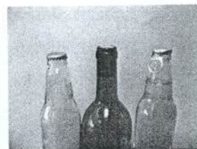
รูปที่ 3 ฝาขวดที่ได้จากการปิดด้วยเครื่องต้นแบบ
