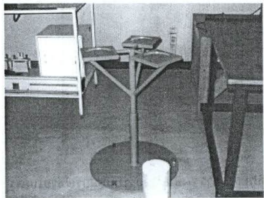
รูปที่ 3 อุปกรณ์ช่วยในการ Cap หัวแท่งตัวอย่างคอนกรีต (ที่สำเร็จแล้ว)
