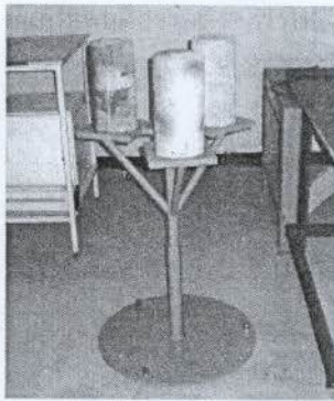
รูปที่ 5 การวางชิ้นตัวอย่างบนอุปกรณ์ช่วยในการ Cap หัวแท่งตัวอย่างคอนกรีต
