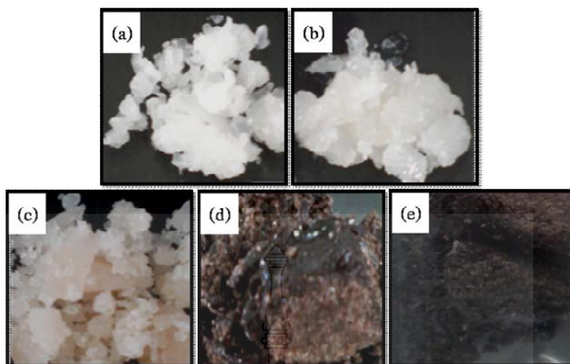
ภาพที่ 4.1 ลักษณะของ PLLA ที่สังเคราะห์ได้ ที่ความเข้มข้นต่างๆของ p-TSA (เปอร์เซ็นต์โดยน้ำหนักของมอนอเมอร์): (a) 2; (b) 4; (c) 8; (d) 10 และ (e) 12
