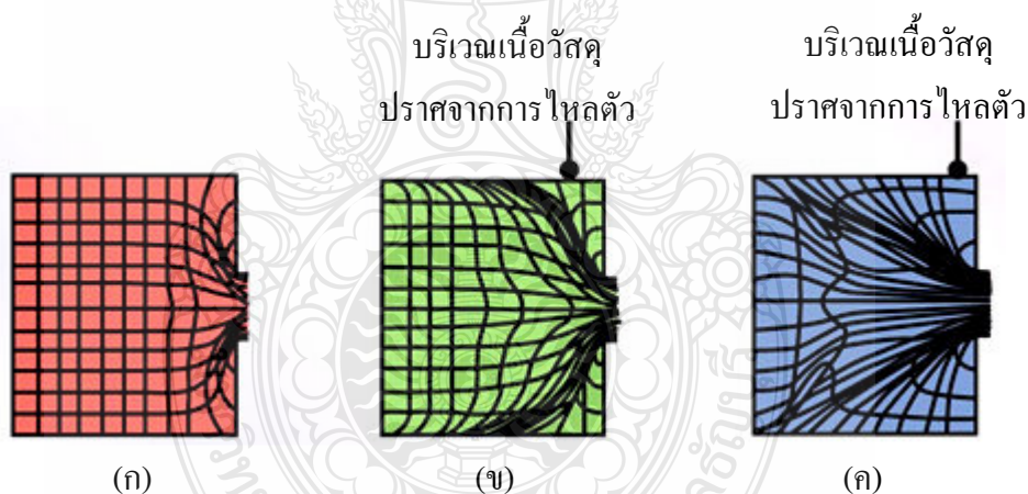
ภาพที่ 2.3 การไหลตัวของชิ้นงานในแม่พิมพ์อัดขึ้นรูป [2]
