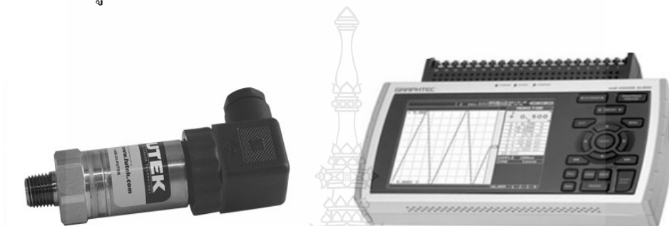
(ก) อุปกรณ์วัดแรงดันน้ำมัน (ข) อุปกรณ์จัดเก็บสัญญาณ
