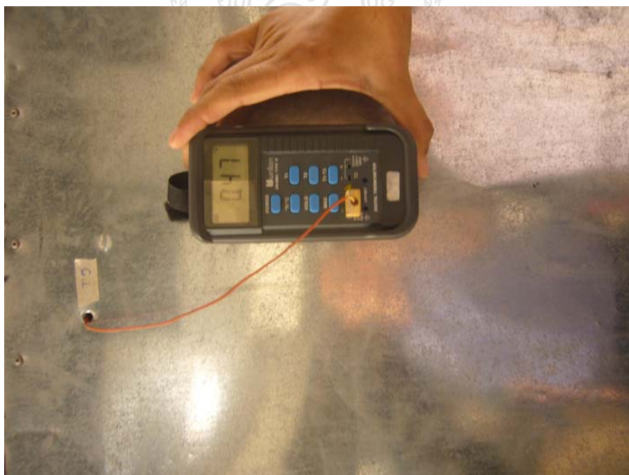
ภาพที่ ก.6 การวัดและเก็บข้อมูลอุณหภูมิความชื้นภายในห้องอบแห้ง
