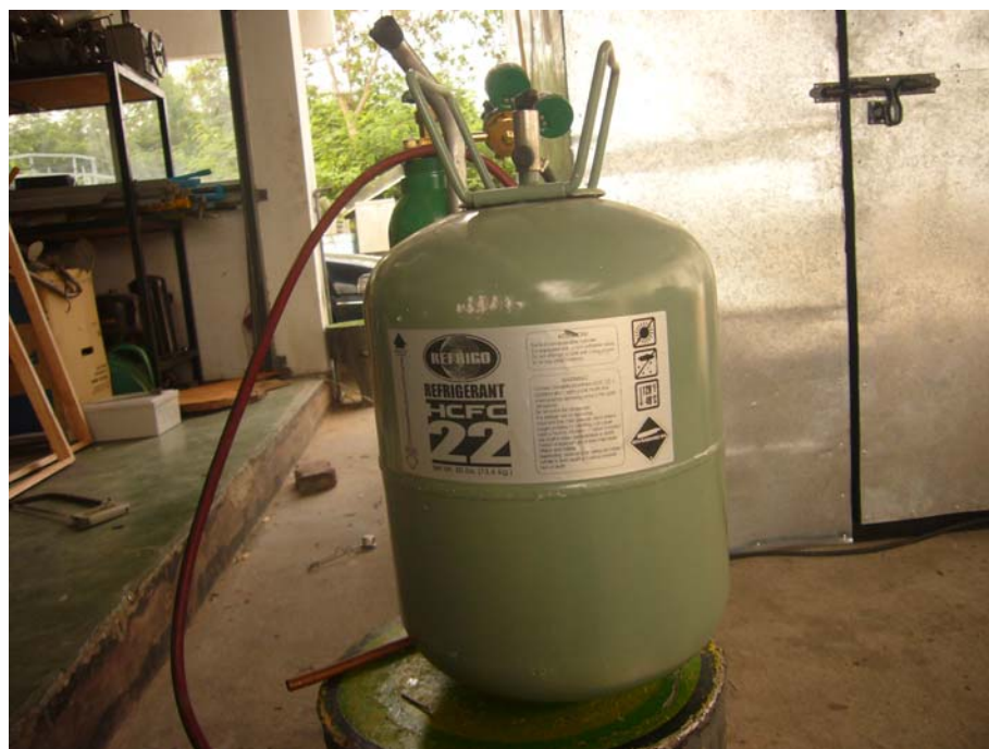
ภาพที่ ก.3 ถังสารทำความเย็น R-22
