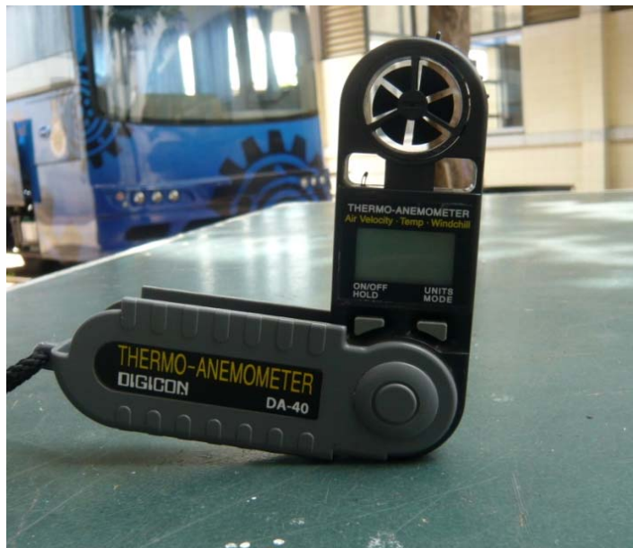
ภาพที่ ก.7 เครื่องมือวัดความเร็วลม (Flow Meter)
