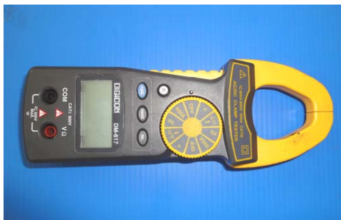
ภาพที่ 3.10 เครื่องมือวัดกระแสไฟฟ้า CLAMP TESTER รุ่น DM-617
