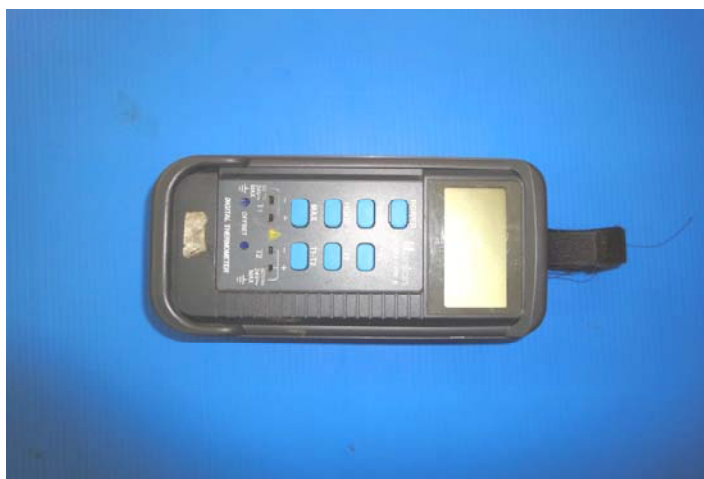
ภาพที่ 3.6 เครื่องมือวัดอุณหภูมิเทอร์โมคัปเปิล TYPE K รุ่น UN-306A
