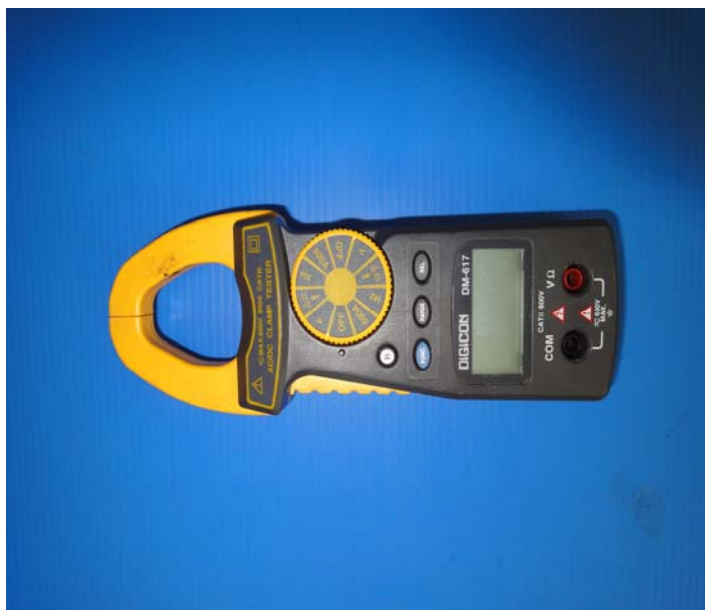
ภาพที่ ก.9 เครื่องมือวัดกระแส ไฟฟ้า (Clip amp)
