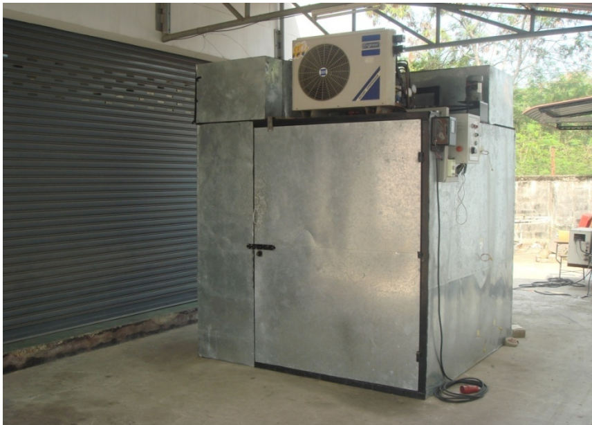
ภาพที่ ก.1 เครื่องอบแห้งที่ใช้ระบบปั๊มความร้อน
