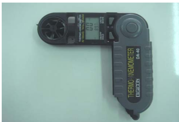
ภาพที่ 3.8 เครื่องวัดความเร็วลม แบบDIGICON รุ่น DA-40
