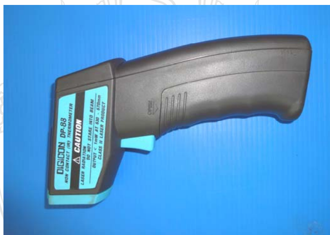
ภาพที่ 3.11 เครื่องมือวัดอุณหภูมิแบบอินฟราเรด รุ่น DP – 88
