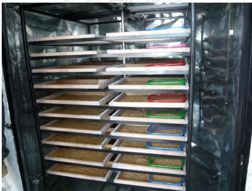
ภาพที่ ก.2 การจัดวางถาดข้าวเปลือกภายในเครื่องอบแห้งที่ใช้ระบบปั๊มความร้อน
