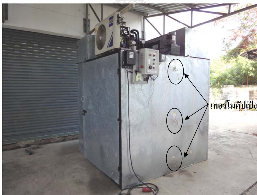
ภาพที่ 3.7 การติดตั้งเทอร์โมคัปเปิลเพื่อใช้วัดอุณหภูมิอากาศตำแหน่งต่างๆภายในตู้อบแห้งที่ใช้ระบบปั๊มความร้อน
