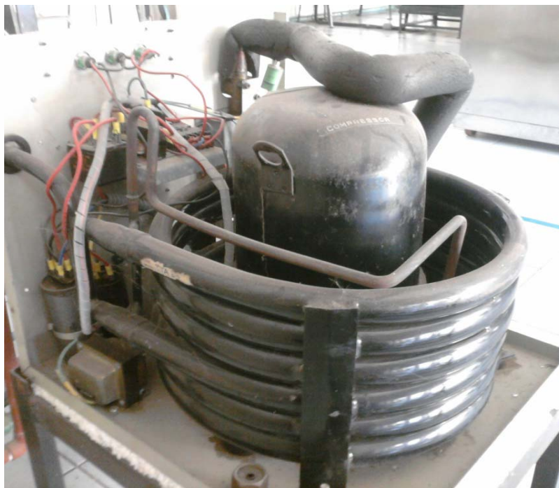
ภาพที่ 2.18 การระบายความร้อนคอมเพรสเซอร์ด้วยน้ำ
