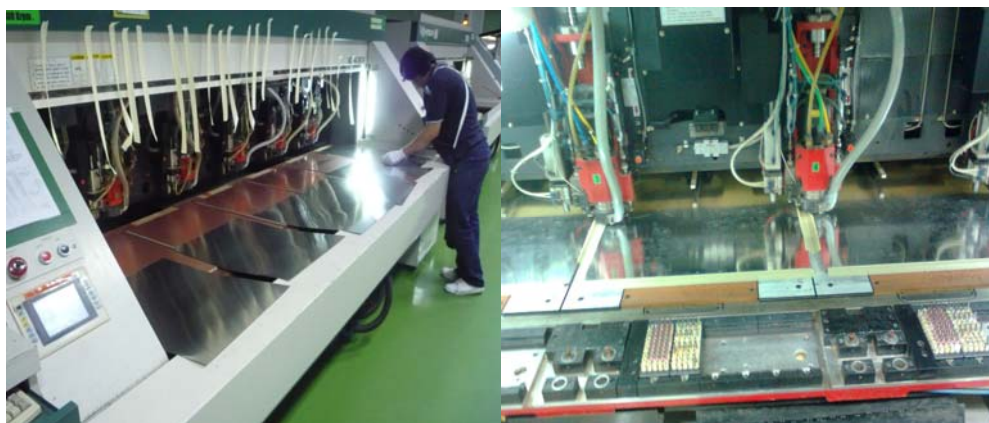
ภาพที่ 2.2 เครื่องเจาะ CNC แบบ 6 หัวเจาะ (6 Spindle Head)
