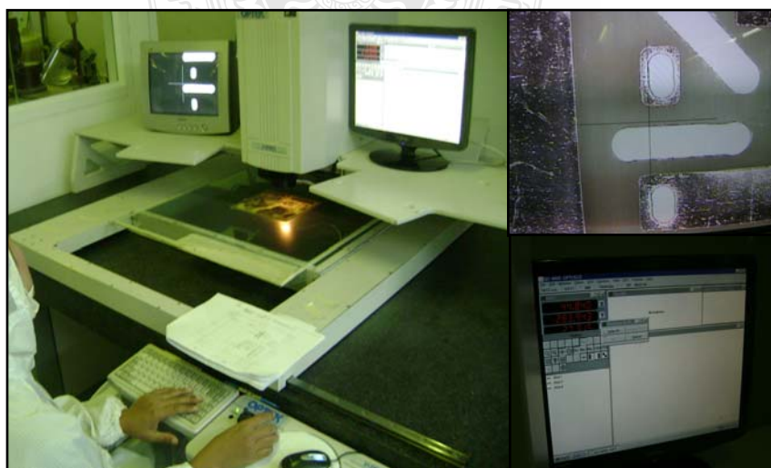
ภาพที่ 3.5 การใช้เครื่อง Optical Measurement วัดขนาด Multi-hit Slot
