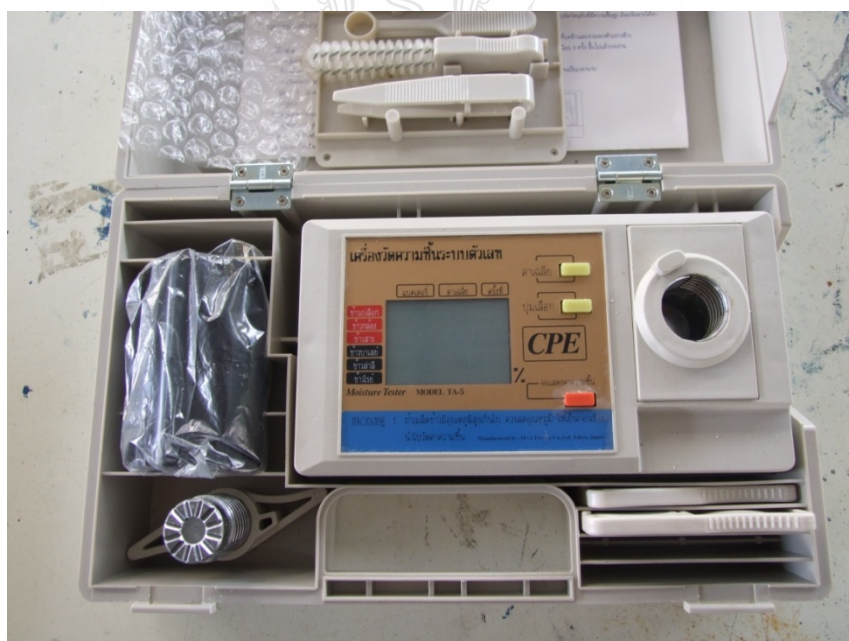
ภาพที่ ค.4 เครื่องวัดความชื้นข้าว
