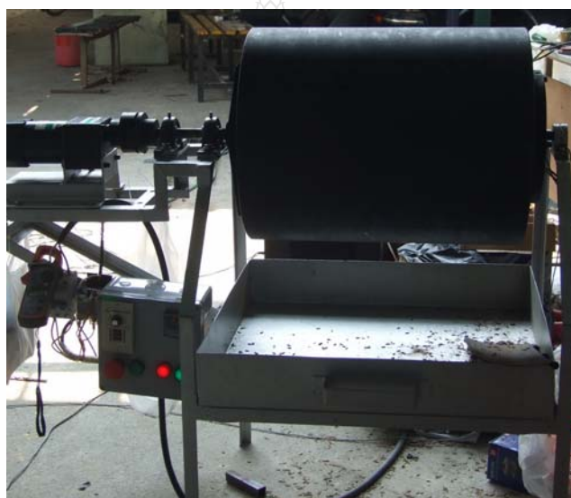
ภาพที่ 3.5 การทดสอบคั่วข้าวมอลต์ด้วยเครื่องคั่วข้าวฮีเตอร์อินฟาเรด
