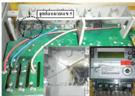
รูปที่ 3 มอเตอร์ AMR ที่ชำรุดพบรอยไหม้ด้านในจุดต่อลงดินหมายเลข 5
