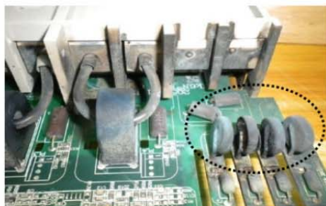
รูปที่ 4 วาริสเตอร์ภายในมอเตอร์ AMR ที่ได้รับความเสียหาย
