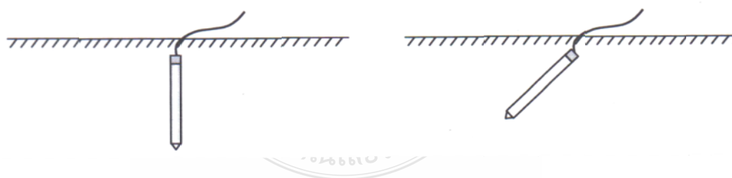
ภาพที่ 2.27 รากสายดินติดตั้งในแนวตั้ง และแนวเอียง [14]
