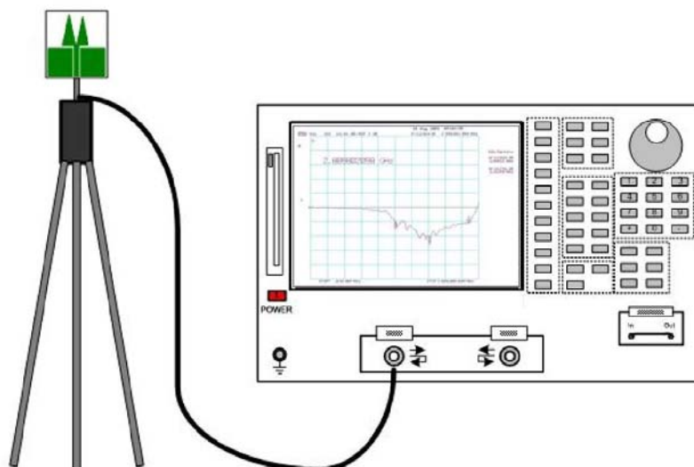
ภาพที่ 4.16 การต่ออุปกรณ์เพื่อใช้วัดค่าความสูญเสียเนื่องจากการย้อนกลับอิมพีแดนซ์ และอัตราส่วนคลื่นนิ่งของแรงดัน
