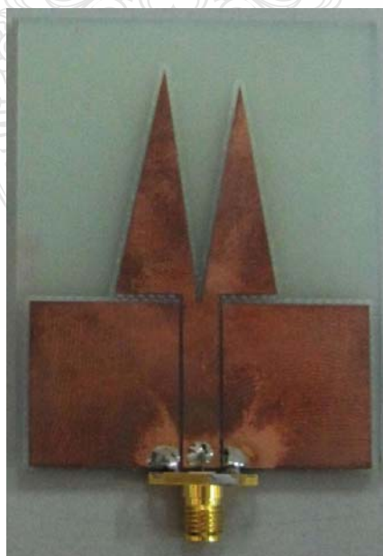
ภาพที่ 3.36 ภาพชิ้นงานจริงของสายอากาศแพทช์รูปสามเหลี่ยมแบบระนาบร่วม
