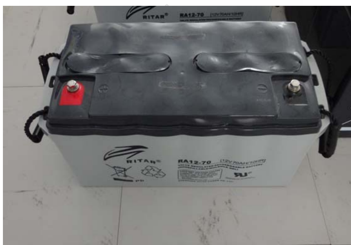
ภาพที่ 5.1 แบตเตอรี่เสียหายจากการทดสอบที่อุณหภูมิสูง 60 °C
