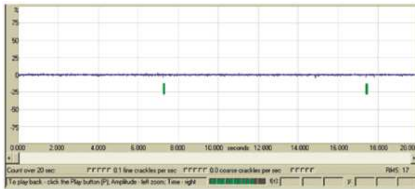
รูปที่ 7 ลักษณะรูปคลื่นความถี่เสียงที่คอมพิวเตอร์แสดงเมื่อตลับลูกปืนทำงานเป็นปกติ
