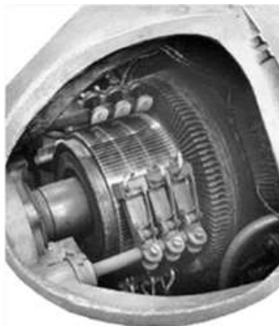
รูปที่ 4 แสดงหน้าตาของแปรงถ่าน และคอมมิวเตเตอร์ ของมอเตอร์กระแสตรง
