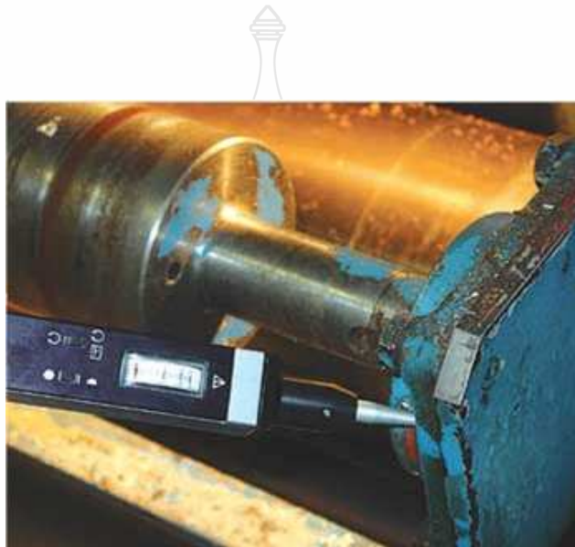
รูปที่ 6 การใช้เซนเซอร์อัลตราโซนิกตรวจสอบตลับลูกปืนมอเตอร์
