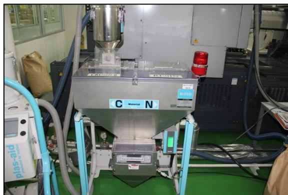
เครื่องผสมแบบควบคุมด้วยน้ำหนักหลังปรับปรุง
