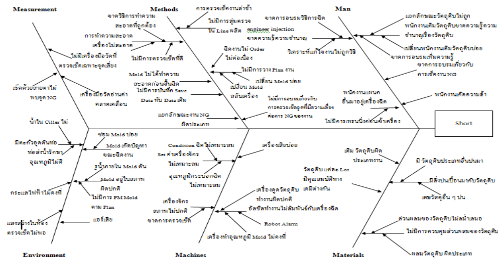
ภาพที่ 4.11 การวิเคราะห์สาเหตุโดยใช้แผนภูมิก้างปลา (Short)
