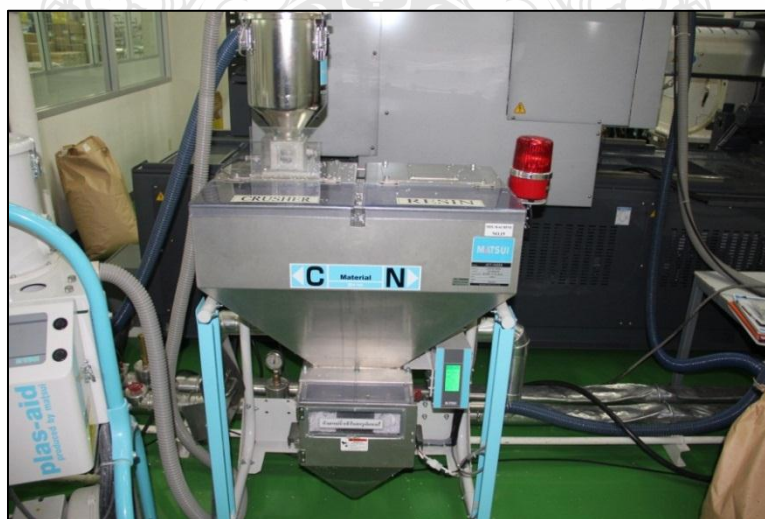
ภาพที่ 2.1 แสดงเครื่องผสมวัตถุดิบระหว่างพลาสติกเข้ากับเม็ดรีไซเคิล
