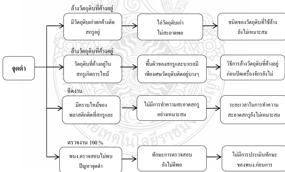
ภาพที่ 4.12 การวิเคราะห์สาเหตุโดยใช้แผนภูมิต้นไม้ (Black Dot)
