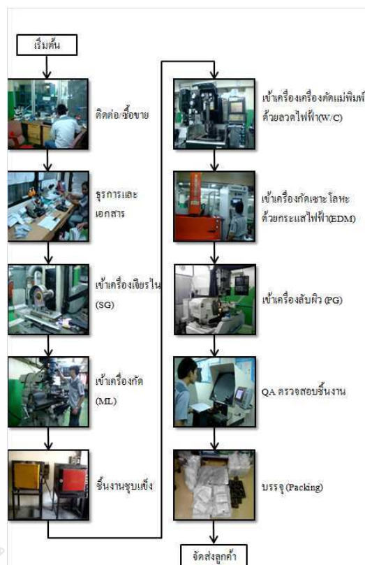
รูปที่ 3 ผังกระบวนการในการผลิตชิ้นงาน
