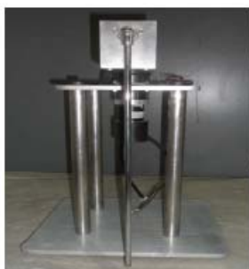
รูปภาพที่ 1 โครงสร้างอินเวอร์ทเพนดูลัมแบบฐานหมุน
