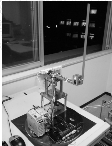
ภาพที่ 2.1 ระบบลูกตุ้มผกผันแบบฐานหมุน [1]
