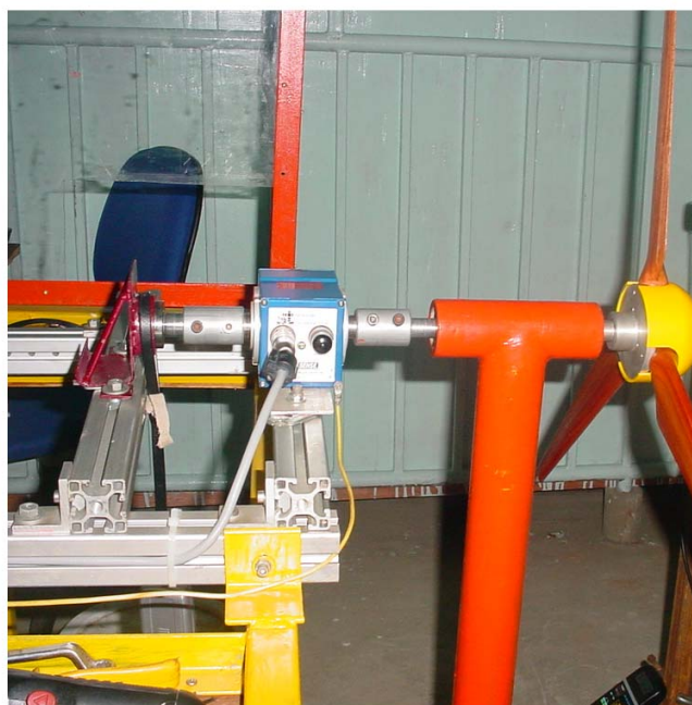
ภาพที่ 3.36 การประกอบชุดเครื่องมือวัดแรงบิด
