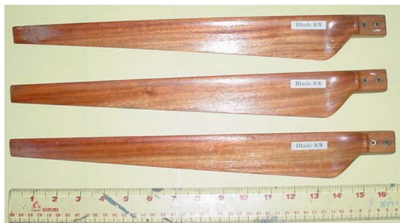
ภาพที่ 3.31 ใบกั้งหันลมต้นแบบย่อส่วน 1 ต่อ15 แบบ 8/8
