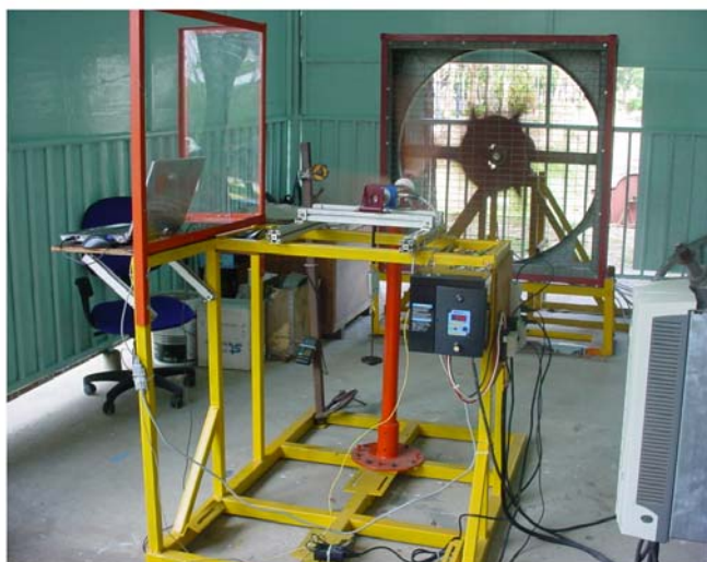
ภาพที่ 3.27 ชุดทดสอบกังหันลม
