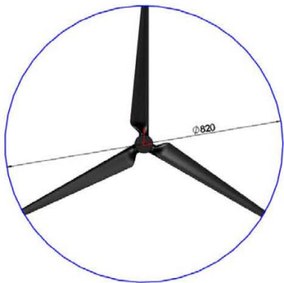
รูปที่ 4 ลักษณะโรเตอร์ที่ใช้กับชุดทดสอบประสิทธิภาพกังหันลม
