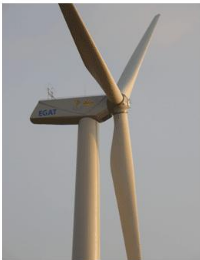
ภาพที่ 1.6 กังหันลมผลิตไฟฟ้าขนาดกำลังผลิต 1,250 กิโลวัตต์ [6]
