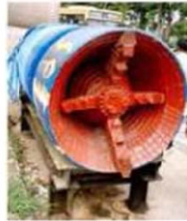
ภาพที่ 20 รูปด้านหน้าหัวเจาะซึ่งจะมีพื้นล่าง หัว วน กัด ดิน แ ถั่ว คูด ดิน ที่ห สม กับสวลงลายเพื่อ นำไปทิ้ง
