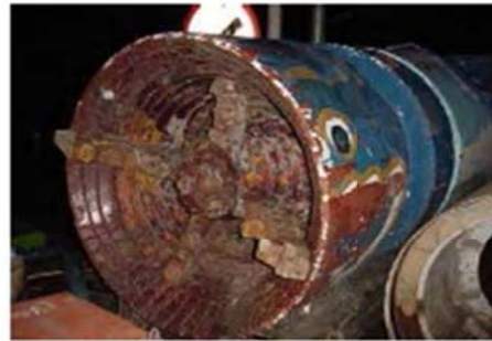
ภาพที่ ๖ แสดงสภาพด้านหน้าหัวเจาะเสียหาย ไปบางส่วนเนื่องจากมีหินขนาดใหญ่พุ่งมา ก่อนคอนกรีตที่หล่อจากงานก่อสร้างจะ
