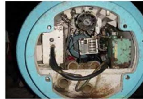
ภาพที่ 21 รูปด้านหลังหัวเจาะซึ่งจะ ประกอบด้วยชุดควบคุมการเจาะดินและ ชุดควบคุมทิศทางการเดิน
