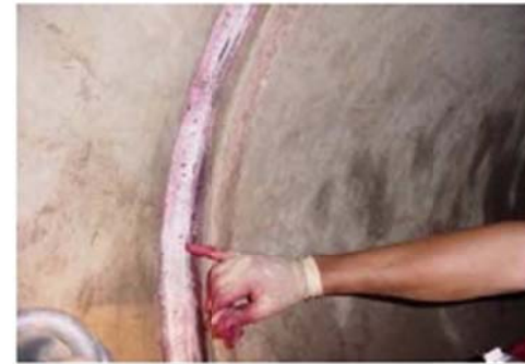
ภาพที่ ๔.๓ หากจุดใดของรอยเชื่อมมีจุดที่เป็นสีแดงลักษณะที่เรียกว่าคอดจะต้องแก้ไขแล้วทำการทดสอบซ้ำ
