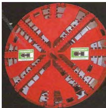
ภาพที่ 2.3 หัวเจาะ Closed Face Shield ชนิด Earth Pressure Balance (EPB)
