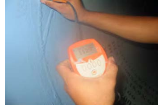
ภาพที่ 48 ตรวจสอบความหนาของสีในท่อ Ultrasonic Thickness Measurement
