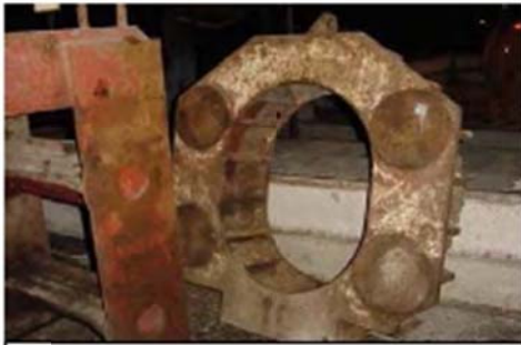
ภาพที่ ๔๖ เครื่องการยก (LIFTING BLOCK) ลงติดตั้ง เพื่อกระจายแรงกดจากแม่แรงที่กระทำต่อท่อ
