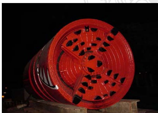
ภาพที่ 5 หัวเจาะแบบปิดหน้า Slurry Shield [4]
