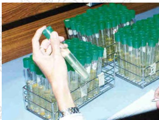
ภาพที่ 2.30 การตรวจสอบคุณภาพน้ำโดยนักวิทยาศาสตร์ก่อนเปิดจ่ายน้ำจากเส้นท่อ
