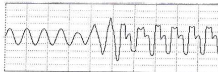
รูปที่ 7 การเกิดเฟอร์โรเรโซแนนซ์ขณะปรับ Tap หม้อแปลงจาก 9 ไป 10
