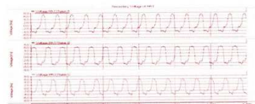
รูปที่ 9. ลักษณะรูปคลื่นแรงดันคร่อมหม้อแปลงรูปแบบที่ 1 ผลการวัด (รูปบน) และผลการจำลองระบบ (รูปล่าง)
