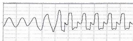
รูปที่ 5 การเกิดเฟอร์โรเรโซแนนซ์ขณะปรับ Tap หม้อแปลงจาก 4 ไป 5
