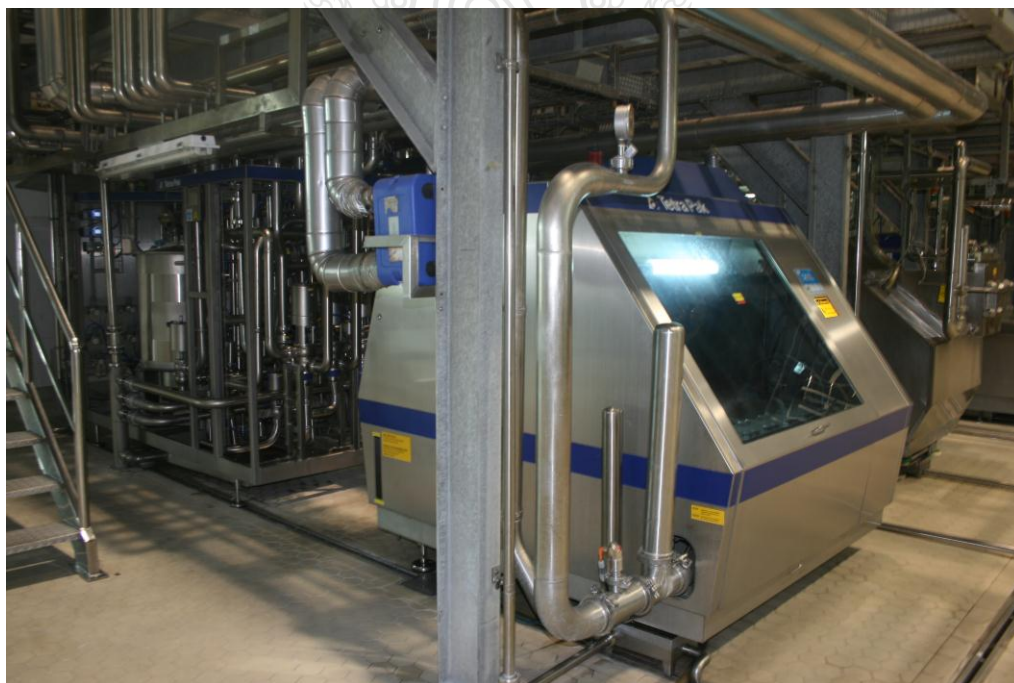
ภาพที่ 3.4 แสดงเครื่องฆ่าเชื้อเครื่องที่ 3
