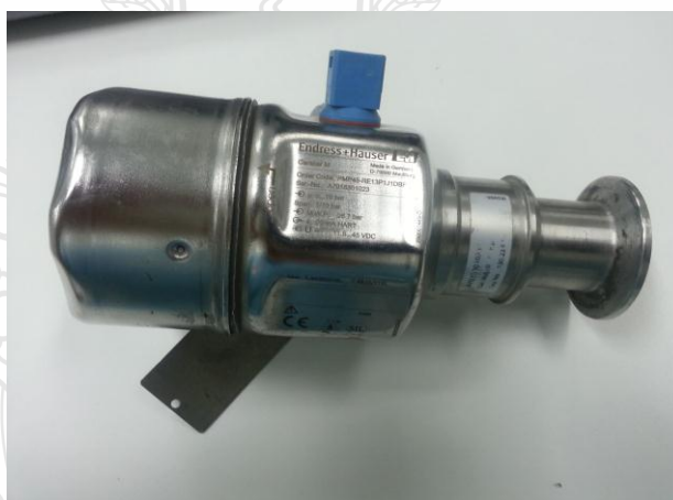
ภาพที่ 4.17 แสดง Pressure Transmitter
